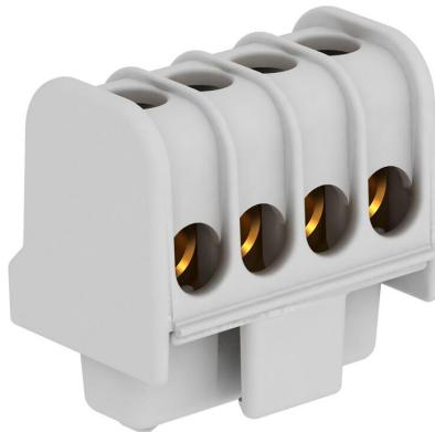
Bornes de latón, tornillos de acero, electrogalvanizados y con pasivado transparente, sección nominal 6 ÷ 16 mm<sup>2</sup>, tensión nominal 400 V, 1 polo, con bloques de terminales, conductor máx. que se puede conectar en cada borne máx. 4x16mm<sup>2</sup>, 4x10mm<sup>2</sup>, 8x6mm<sup>2</sup> o 12x4mm<sup>2</sup>.
