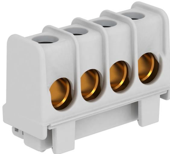
Bornes de latón, tornillos de acero, electrogalvanizados y con pasivado transparente, sección nominal 16 ÷ 35 mm<sup>2</sup>, tensión nominal 400 V, 1 polo, con bloques de terminales, conductor máx. que se puede conectar en cada borne máx. 4x35mm<sup>2</sup>, 4x25mm<sup>2</sup>, 8x16mm<sup>2</sup> o 12x10mm<sup>2</sup>.
