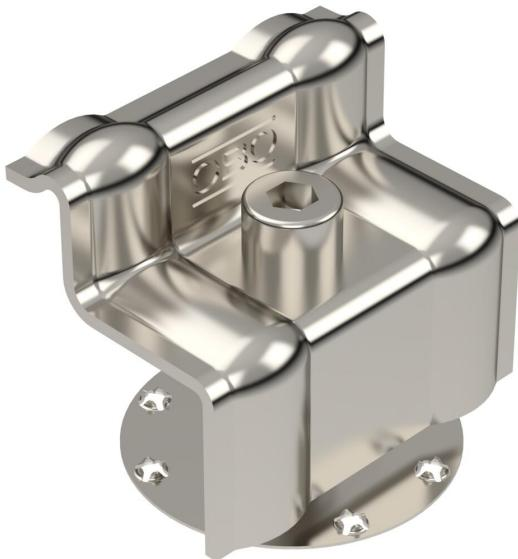
Abrazadera final con muelle para la fijación de módulos fotovoltaicos en perfiles de soporte. Apto para ancho de ranura de 10 mm. Fijación atornillable del módulo fotovoltaico con llave Allen tamaño 6.
