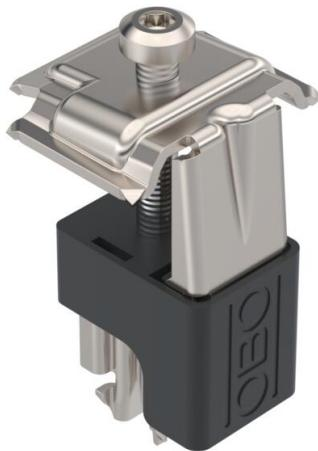
Grapa universal para el montaje de módulos fotovoltaicos en tejados planos e inclinados, adecuada como abrazadera entre 2 módulos o como abrazadera final. Fijación previa por encaje al perfil TP 45 y a los soportes STK y STL. Apta para ancho de ranura de 10 mm. Una vez encajada, puede girarse 90°. Fijación atornillada del módulo FV con llave Torx 30.
