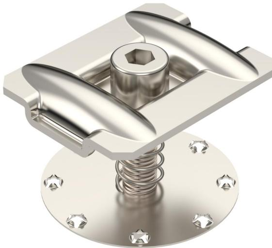
Grapa intermedia con muelle para la fijación de módulos fotovoltaicos en perfiles de soporte. Apto para ancho de ranura de 10 mm. Fijación atornillable del módulo fotovoltaico con llave Allen tamaño 6.
