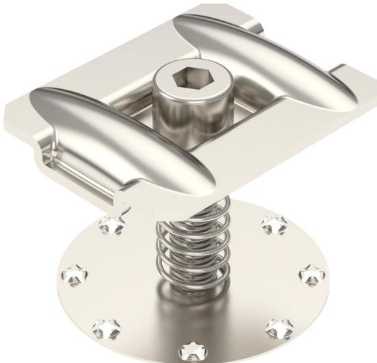
Abrazadera intermedia con muelle para la fijación de módulos fotovoltaicos en perfiles de soporte. Apto para ancho de ranura de 10 mm. Fijación atornillable del módulo fotovoltaico con llave Allen tamaño 6.
