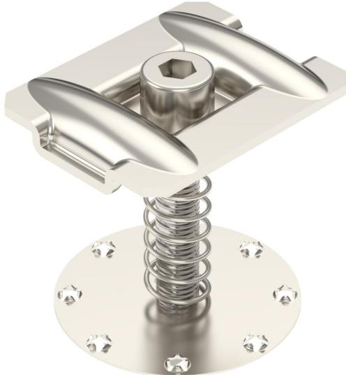
Abrazadera intermedia con muelle para la fijación de módulos fotovoltaicos en perfiles de soporte. Apto para ancho de ranura de 10 mm. Fijación atornillable del módulo fotovoltaico con llave Allen tamaño 6.
