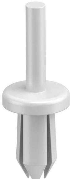
Para un montaje rápido y un funcionamiento óptimo hay que utilizar la remachadora KNW2. Tamaño del agujero perforado: 6,5 mm.
