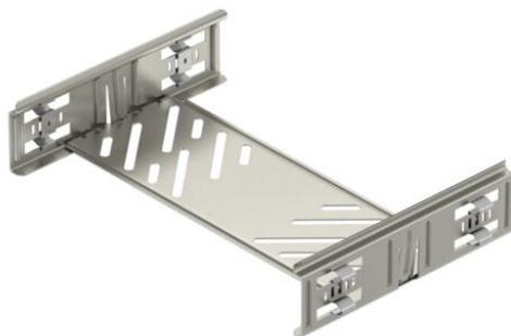
Conector de bandeja portacables con fijación rápida para la unión sin tornillos de bandejas portacables perforadas con ala de 60 mm. Gracias a la forma constructiva optimizada, el conector se puede instalar para formar radios y como pieza de compensación longitudinal en caso de grandes oscilaciones de temperatura.
