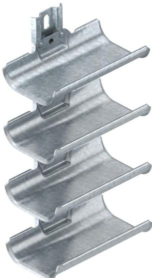
Soporte portacables para tendido de cables rápido y sencillo en áreas de aplicación, en las que no pueden montarse sistemas de bandejas portacables convencionales por motivos de espacio. Los soportes disponen de una amplia superficie de instalación y bordes exteriores redondeados para proteger los cables.
