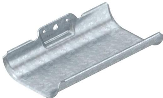
Soporte portacables para tendido de cables rápido y sencillo en áreas de aplicación, en las que no pueden montarse sistemas de bandejas portacables convencionales por motivos de espacio. Los soportes disponen de una amplia superficie de instalación y bordes exteriores redondeados para proteger los cables.
