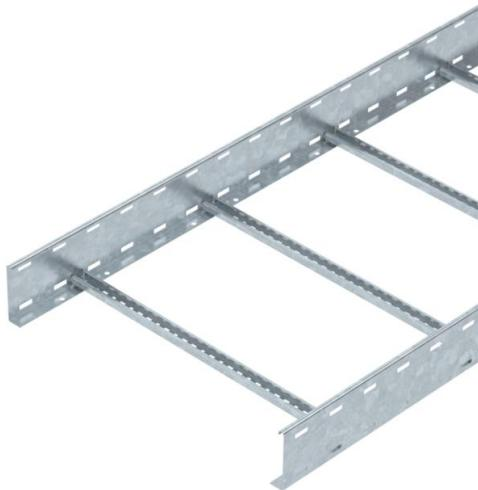
Bandeja de escalera con ala de 110 mm con peldaños de perfil C30 soldados, abiertos hacia arriba. Barra lateral enrollada como refuerzo y como protección de bordes. La fijación en la escuadra se realiza con bridas de fijación LKS 40. La medida de la ranura del peldaño es de 16,5 mm; la abrazadera de media caña sobre perfil adecuada es 2056. Aislamiento magnético sin tapa 10 dB, con tapa 15 dB.
