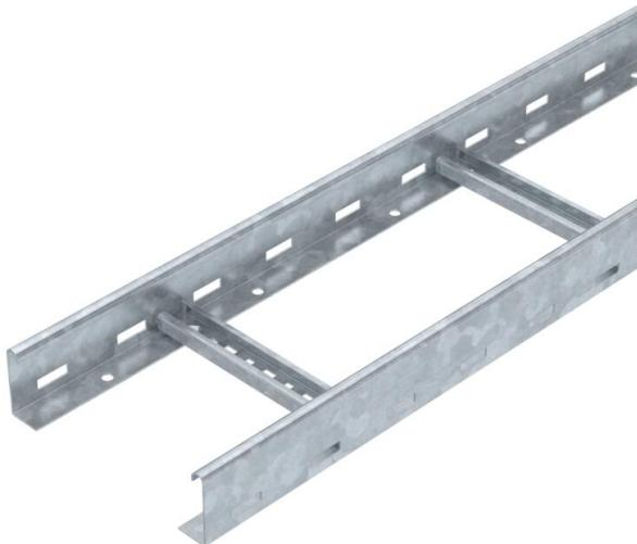
Bandeja de escalera con altura de ala de 60 mm con peldaños de perfil C30 soldados, abiertos hacia arriba. Barra lateral enrollada como refuerzo y como protección de bordes. La fijación en la escuadra se realiza con bridas de fijación LKS 40. La medida de la ranura del peldaño es de 16,5 mm; la abrazadera de media caña sobre perfil adecuada es BS-H....
