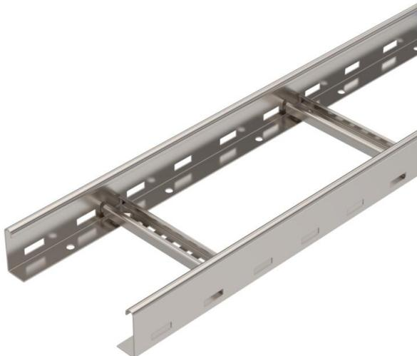
Bandeja de escalera con ala de 60 mm con peldaños de perfil C30 soldados, abiertos hacia arriba. Barra lateral enrollada como refuerzo y como protección de bordes. La fijación en la escuadra se realiza con bridas de fijación LKS 40. La medida de la ranura del peldaño es de 16,5 mm; la abrazadera de media caña sobre perfil adecuada es 2056. Aislamiento magnético sin tapa 10 dB, con tapa 15 dB.
