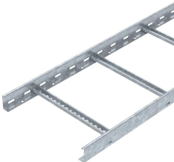
Bandeja de escalera con altura de ala de 60 mm con peldaños de perfil C30 soldados, abiertos hacia arriba. Barra lateral enrollada como refuerzo y como protección de bordes. La fijación en la escuadra se realiza con bridas de fijación LKS 40. La medida de la ranura del peldaño es de 16,5 mm; la abrazadera de media caña sobre perfil adecuada es BS-H....
