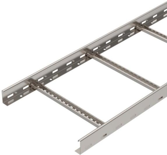
Bandeja de escalera con ala de 60 mm con peldaños de perfil C30 soldados, abiertos hacia arriba. Barra lateral enrollada como refuerzo y como protección de bordes. La fijación en la escuadra se realiza con bridas de fijación LKS 40. La medida de la ranura del peldaño es de 16,5 mm; la abrazadera de media caña sobre perfil adecuada es 2056. Aislamiento magnético sin tapa 10 dB, con tapa 15 dB.
