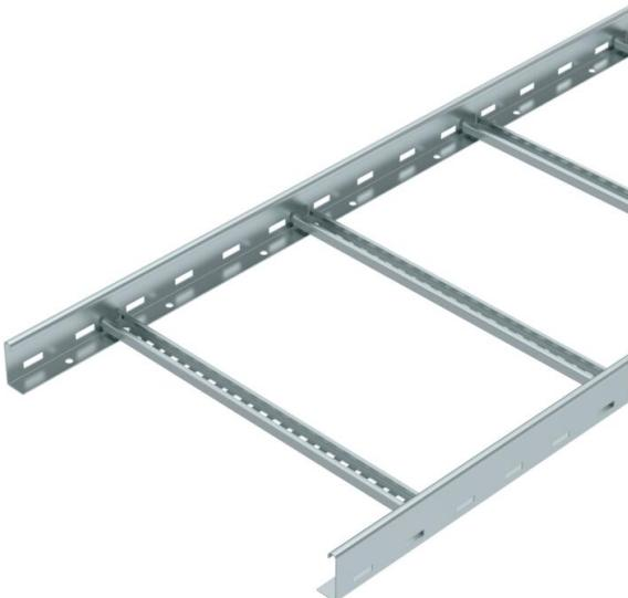
Bandeja de escalera con altura de ala de 60 mm con peldaños de perfil C30 soldados, abiertos hacia arriba. Barra lateral enrollada como refuerzo y como protección de bordes. La fijación en la escuadra se realiza con bridas de fijación LKS 40. La medida de la ranura del peldaño es de 16,5 mm; la abrazadera de media caña sobre perfil adecuada es 2056. Aislamiento magnético sin tapa 10 dB, con tapa 15 dB.
