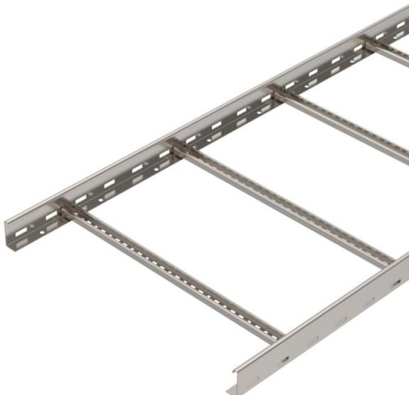
Bandeja de escalera con ala de 60 mm con peldaños de perfil C30 soldados, abiertos hacia arriba. Barra lateral enrollada como refuerzo y como protección de bordes. La fijación en la escuadra se realiza con bridas de fijación LKS 40. La medida de la ranura del peldaño es de 16,5 mm; la abrazadera de media caña sobre perfil adecuada es 2056. Aislamiento magnético sin tapa 10 dB, con tapa 15 dB.
