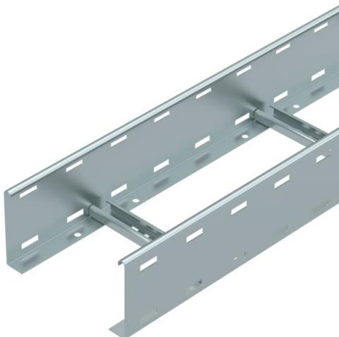
Bandeja de escalera con barra lateral perforada de ala 110 mm con peldaños de perfil en C abiertos hacia arriba, remachados.
