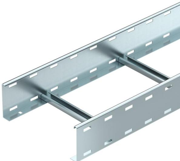
Bandeja de escalera con barra lateral perforada de ala 110 mm con peldaños de perfil en C abiertos hacia arriba, remachados.
