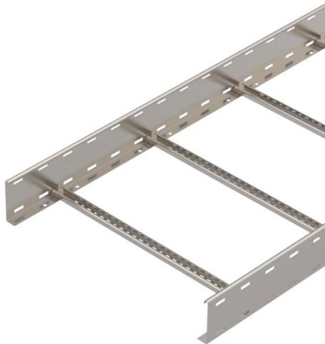
Bandeja de escalera con ala perforada de 110 mm con peldaños de perfil en C abiertos hacia arriba, remachados.
