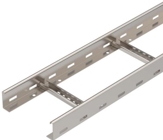
Bandeja de escalera con barra lateral perforada de ala 60 mm con peldaños de perfil en C abiertos hacia arriba (modelo VS), remachados.
