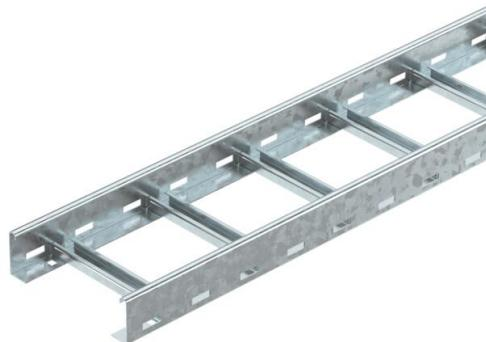
Bandeja de escalera para el tendido horizontal de cables y líneas. Se puede utilizar en anchos de 200 - 400 mm como estructura de soporte estándar para el mantenimiento de función según DIN 4102 parte 12. Clases de mantenimiento de función de E30 a E90. Con remache de perfil en C remachado abierto en la parte superior.
