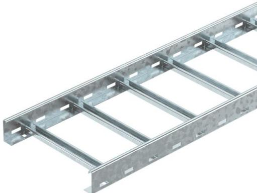
Bandeja de escalera para el tendido horizontal de cables y líneas. Se puede utilizar en anchos de 200 - 400 mm como estructura de soporte estándar para el mantenimiento de función según DIN 4102 parte 12. Clases de mantenimiento de función de E30 a E90. Con remache de perfil en C remachado abierto en la parte superior.
