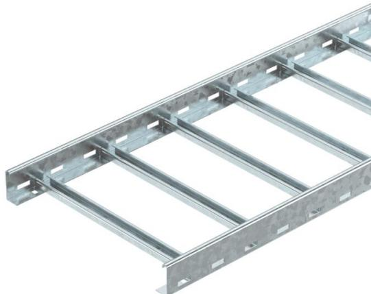
Bandeja de escalera para el tendido horizontal de cables y líneas. Se puede utilizar en anchos de 200 - 400 mm como estructura de soporte estándar para el mantenimiento de función según DIN 4102 parte 12. Clases de mantenimiento de función de E30 a E90. Con remache de perfil en C remachado abierto en la parte superior.
