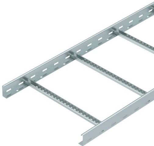
Bandeja de escalera con barra lateral perforada de ala 60 mm con peldaños de perfil en C abiertos hacia arriba (modelo VS), remachados. La bandeja de escalera se suministra plegada.
