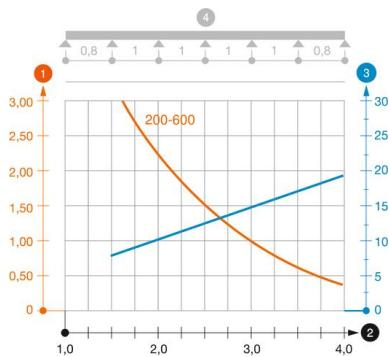
Diagrama de carga bandeja de escalera tipo LG 60 VS
