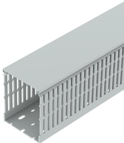
Canal de cableado libre de halógenos incl. parte superior y perforación en la base para el tendido horizontal y vertical de cables eléctricos y líneas en el cuadro eléctrico. Con cinta adhesiva de doble cara en la base del canal como ayuda de montaje. Versión como canal métrico. Los puentes pueden romperse sin necesidad de herramientas. Longitudes especiales disponibles previa solicitud.
