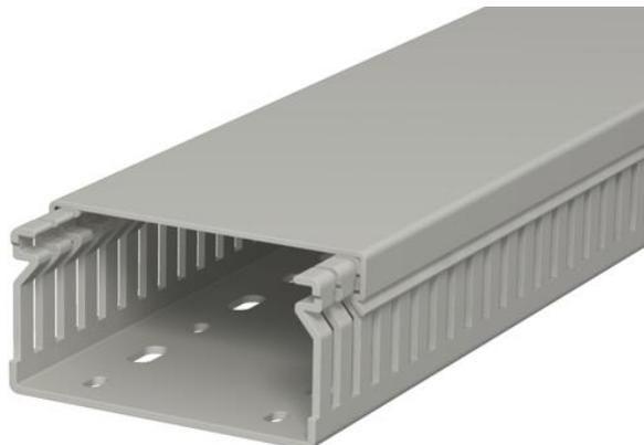
Canal de cableado incl. parte superior y perforación en la base para el tendido horizontal y vertical de cables eléctricos y líneas en el cuadro eléctrico. Versión como canal métrico. La dimensión nominal del tamaño del sistema corresponde a la dimensión interior de los canales. Los puentes pueden romperse sin necesidad de herramientas. Los puntos de rotura predefinidos permiten la instalación a ras de suelo. Probado según DIN EN 50085-2-3. Longitudes especiales disponibles previa solicitud.
