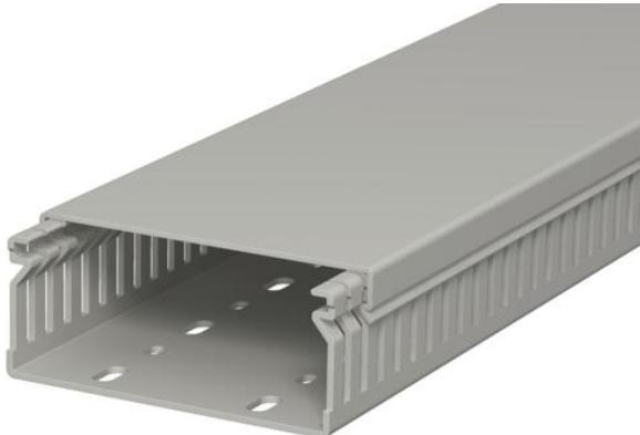
Canal de cableado incl. parte superior y perforación en la base para el tendido horizontal y vertical de cables eléctricos y líneas en el cuadro eléctrico. Versión como canal métrico. La dimensión nominal del tamaño del sistema corresponde a la dimensión interior de los canales. Los puentes pueden romperse sin necesidad de herramientas. Los puntos de rotura predefinidos permiten la instalación a ras de suelo. Probado según DIN EN 50085-2-3. Longitudes especiales disponibles previa solicitud.
