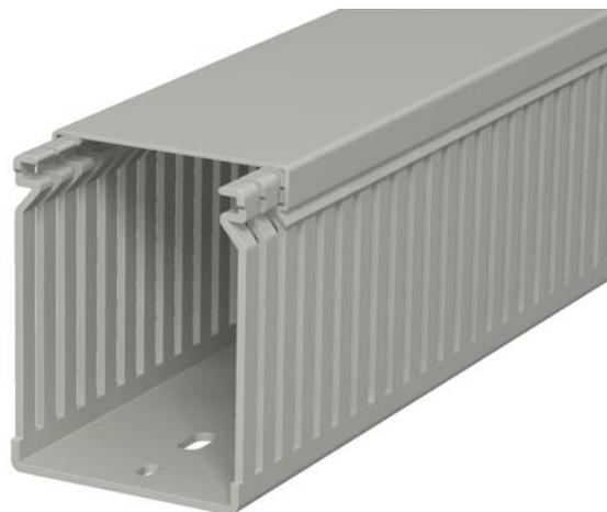
Canal de cableado incl. parte superior y perforación en la base para el tendido horizontal y vertical de cables eléctricos y líneas en el cuadro eléctrico. Versión como canal métrico. La dimensión nominal del tamaño del sistema corresponde a la dimensión interior de los canales. Los puentes pueden romperse sin necesidad de herramientas. Los puntos de rotura predefinidos permiten la instalación a ras de suelo. Probado según DIN EN 50085-2-3. Longitudes especiales disponibles previa solicitud.
