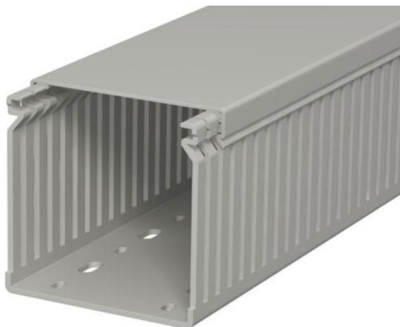
Canal de cableado incl. parte superior y perforación en la base para el tendido horizontal y vertical de cables eléctricos y líneas en el cuadro eléctrico. Versión como canal métrico. La dimensión nominal del tamaño del sistema corresponde a la dimensión interior de los canales. Los puentes pueden romperse sin necesidad de herramientas. Los puntos de rotura predefinidos permiten la instalación a ras de suelo. Probado según DIN EN 50085-2-3. Longitudes especiales disponibles previa solicitud.
