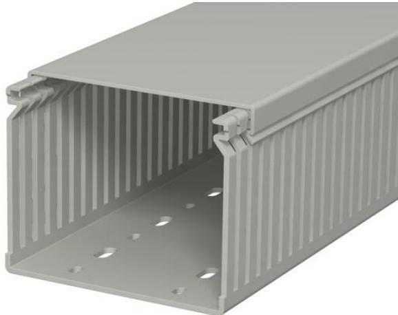
Canal de cableado incl. parte superior y perforación en la base para el tendido horizontal y vertical de cables eléctricos y líneas en el cuadro eléctrico. Versión como canal métrico. La dimensión nominal del tamaño del sistema corresponde a la dimensión interior de los canales. Los puentes pueden romperse sin necesidad de herramientas. Los puntos de rotura predefinidos permiten la instalación a ras de suelo. Probado según DIN EN 50085-2-3. Longitudes especiales disponibles previa solicitud.
