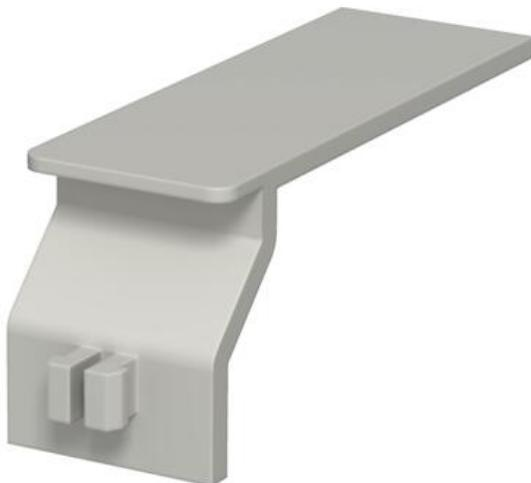
Retenedor de cables para conductos de cableado tipo LK4 y LK4 N. El retenedor de cables impide que los cables ya instalados se caigan. Mediante los puntos de rotura controlada se puede reducir la longitud para diferentes anchos de canal a 38, 28 y 23 mm.
