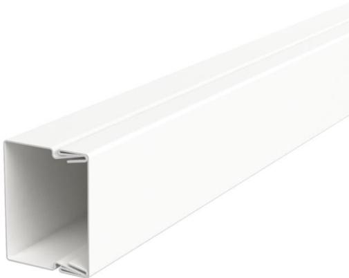
Tapa de canal y base con orificios. La conexión equipotencial entre la base y la tapa del canal está garantizada sin necesidad de ningún elemento adicional. El canal tipo LKM 20030 está testado como sistema de instalación para mantenimiento de función según DIN 4102, parte 12. ¡Tenga en cuenta los tipos de cable probados en el área BSS de sistemas de protección contra incendios!
