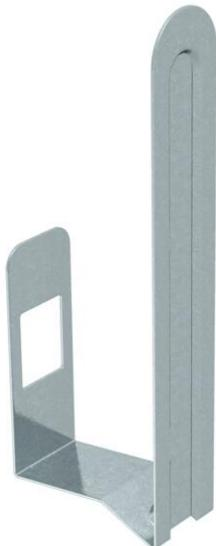
Los retenedores sujetan el cable y las líneas al canal facilitando la instalación a la pared y al techo. Los retenedores se fijan en el interior del canal. Para ancho de canal de 150 mm y 200 mm.
