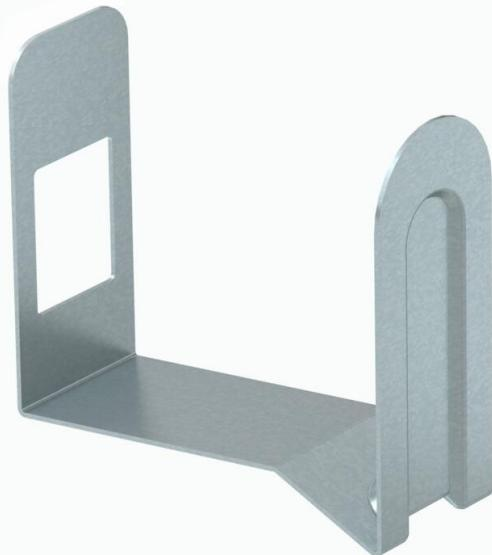
Los retenedores sujetan el cable y las líneas al canal facilitando la instalación a la pared y al techo. Los retenedores se fijan en el interior del canal. Para ancho de canal de 80 mm.
