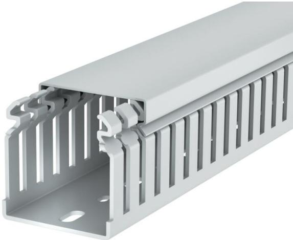
Canal de cableado libre de halógenos según DIN EN 50085-2-3 incl. parte superior y perforación en la base para el tendido horizontal y vertical de cables eléctricos y líneas en el cuadro eléctrico. Versión como canal DIN. Los puentes pueden romperse sin necesidad de herramientas. Los puntos de rotura predefinidos permiten la instalación a ras de suelo. Probado según DIN EN 50085-2-3. Longitudes especiales disponibles previa solicitud.
