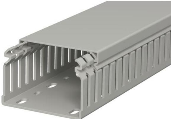
Canal de cableado según DIN EN 50085-2-3 incl. parte superior y perforación en la base para el tendido horizontal y vertical de cables eléctricos y líneas en el cuadro eléctrico. Versión como canal DIN. Los puentes pueden romperse sin necesidad de herramientas. Los puntos de rotura predefinidos permiten la instalación a ras de suelo. Probado según DIN EN 50085-2-3. Longitudes especiales disponibles previa solicitud.
