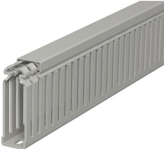
Canal de cableado según DIN EN 50085-2-3 incl. parte superior y perforación en la base para el tendido horizontal y vertical de cables eléctricos y líneas en el cuadro eléctrico. Versión como canal DIN. Los puentes pueden romperse sin necesidad de herramientas. Los puntos de rotura predefinidos permiten la instalación a ras de suelo. Probado según DIN EN 50085-2-3. Longitudes especiales disponibles previa solicitud.
