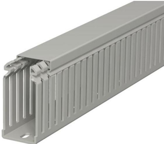
Canal de cableado según DIN EN 50085-2-3 incl. parte superior y perforación en la base para el tendido horizontal y vertical de cables eléctricos y líneas en el cuadro eléctrico. Versión como canal DIN. Los puentes pueden romperse sin necesidad de herramientas. Los puntos de rotura predefinidos permiten la instalación a ras de suelo. Probado según DIN EN 50085-2-3. Longitudes especiales disponibles previa solicitud.
