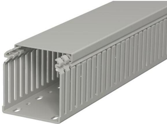
Canal de cableado según DIN EN 50085-2-3 incl. parte superior y perforación en la base para el tendido horizontal y vertical de cables eléctricos y líneas en el cuadro eléctrico. Versión como canal DIN. Los puentes pueden romperse sin necesidad de herramientas. Los puntos de rotura predefinidos permiten la instalación a ras de suelo. Probado según DIN EN 50085-2-3. Longitudes especiales disponibles previa solicitud.
