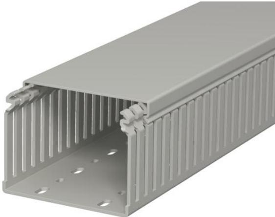
Canal de cableado según DIN EN 50085-2-3 incl. parte superior y perforación en la base para el tendido horizontal y vertical de cables eléctricos y líneas en el cuadro eléctrico. Versión como canal DIN. Los puentes pueden romperse sin necesidad de herramientas. Los puntos de rotura predefinidos permiten la instalación a ras de suelo. Probado según DIN EN 50085-2-3. Longitudes especiales disponibles previa solicitud.
