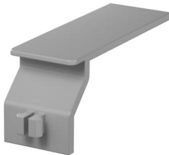
Retenedor de cables para conductos de cableado tipo LKV y LKV N. El retenedor de cables impide que los cables ya instalados se caigan. Mediante los puntos de rotura controlada se puede reducir la longitud para diferentes anchos de canal a 38, 28 y 23 mm.
