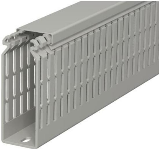
Canal de cableado según DIN EN 50085-2-3 incl. parte superior y perforación en la base para el tendido horizontal y vertical de cables eléctricos y líneas en el cuadro eléctrico. Versión como canal DIN. Los puentes pueden romperse sin necesidad de herramientas. Los puntos de rotura predefinidos permiten la instalación a ras de suelo. Los estrechamientos en las ranuras laterales impiden la caída de los cables. Probado según DIN EN 50085-2-3. Longitudes especiales disponibles previa solicitud.
