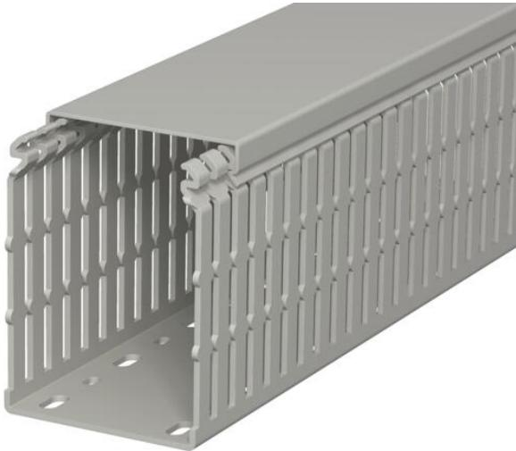
Canal de cableado según DIN EN 50085-2-3 incl. parte superior y perforación en la base para el tendido horizontal y vertical de cables eléctricos y líneas en el cuadro eléctrico. Versión como canal DIN. Los puentes pueden romperse sin necesidad de herramientas. Los puntos de rotura predefinidos permiten la instalación a ras de suelo. Los estrechamientos en las ranuras laterales impiden la caída de los cables. Probado según DIN EN 50085-2-3. Longitudes especiales disponibles previa solicitud.
