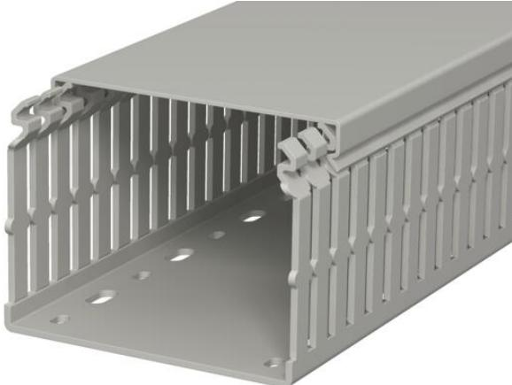
Canal de cableado según DIN EN 50085-2-3 incl. parte superior y perforación en la base para el tendido horizontal y vertical de cables eléctricos y líneas en el cuadro eléctrico. Versión como canal DIN. Los puentes pueden romperse sin necesidad de herramientas. Los puntos de rotura predefinidos permiten la instalación a ras de suelo. Los estrechamientos en las ranuras laterales impiden la caída de los cables. Probado según DIN EN 50085-2-3. Longitudes especiales disponibles previa solicitud.
