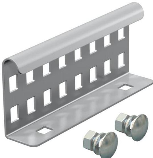
Unión recta como unión exterior para la conexión de puentes de cables y piezas preformadas de ala 60 mm y perforación continua del carril. La continuidad eléctrica de la conexión equipotencial se asegura mediante la unión roscada.
