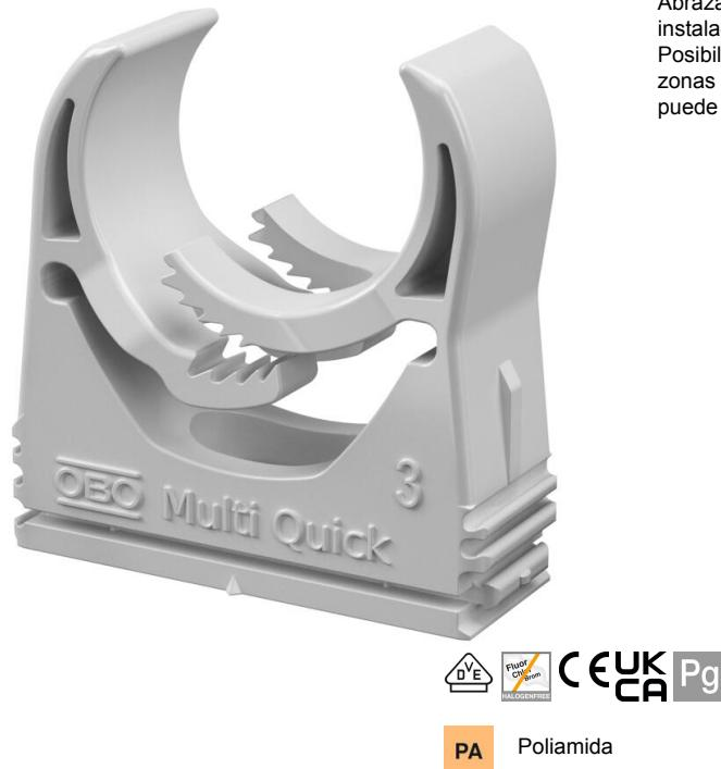
Abrazadera de superficie para la fijación de tubos métricos y PG, y tubos para instalación eléctrica Quick-Pipe. Rango de sujeción flexible de varios milímetros. Posibilidades de fijación universales en pared y techo, y utilizable en perfiles en zonas interiores y exteriores protegidas. Montaje de tubo sin herramientas. Se puede colocar en línea también con abrazadera Quick o starQuick de OBO.
