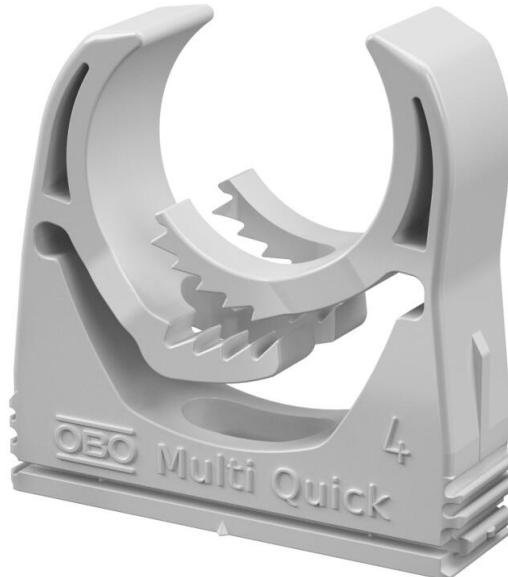
Abrazadera de superficie para la fijación de tubos métricos y PG, y tubos para instalación eléctrica Quick-Pipe. Rango de sujeción flexible de varios milímetros. Posibilidades de fijación universales en pared y techo, y utilizable en perfiles en zonas interiores y exteriores protegidas. Montaje de tubo sin herramientas. Se puede colocar en línea también con abrazadera Quick o starQuick de OBO.
